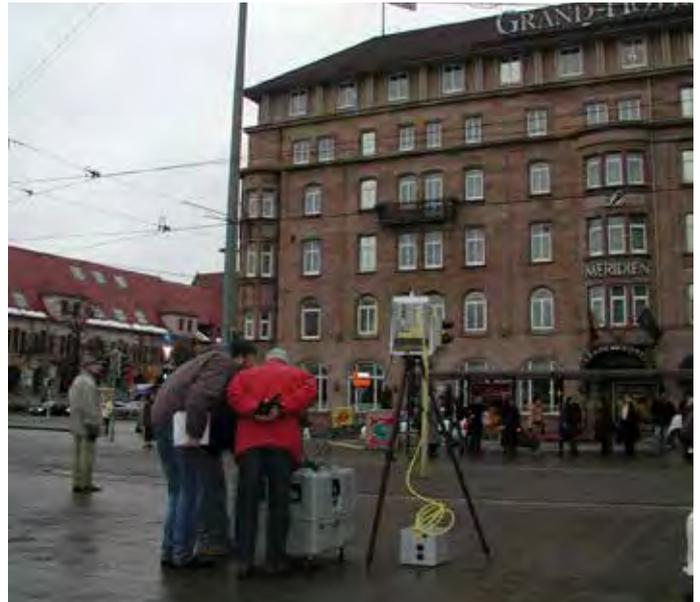
Erste Fassadenaufnahme mit dem Scanner Cyrax 2500 (2003)
