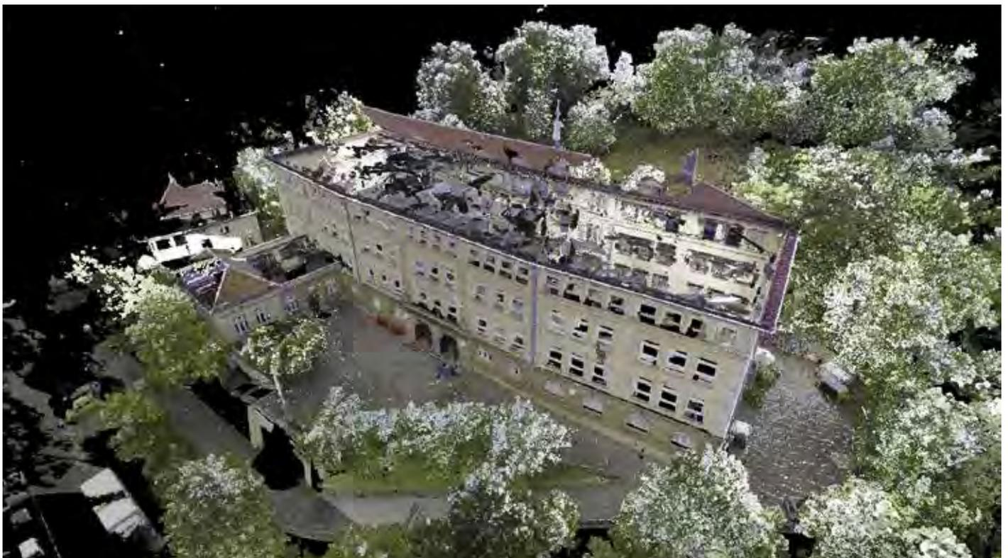
Aktueller Stand: Aus mehreren Aufnahmestandpunkten zusammengesetzte Punktwolke mit überlagerter Farbinformation der Kaufmännischen Schule in Stuttgart-Süd
